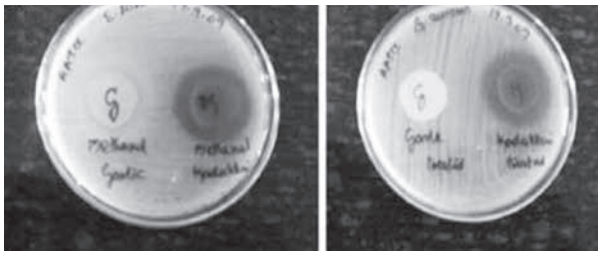
شکل ۱. تست نفوذ آگار روی پارچه پنبه‌ای عمل شده [منطقه بازدارنده در برابر (a) اشیریشیا کولای و (b) استافیلوکوک اورئوس]
